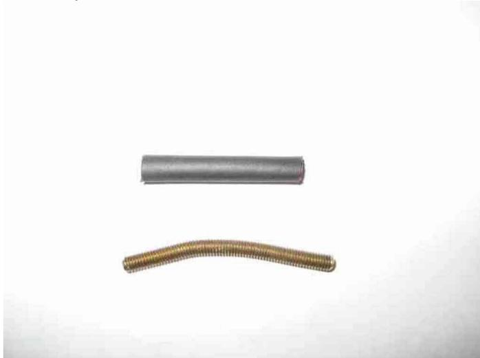
Dann wird der Schrumpfschlauch über den gebogenen Gewindestab geschoben (mittig) und mit dem Fön o.ä. aufgeschrumpft. Dann wird die Einheit vormontiert, das sieht dann aus wie auf dem folgenden Foto. Achtung: der von uns demontierte CY hatte nirgendwo Schraubensicherung dran, es ist aber auf jeden Fall anzuraten, alle Schraubengewinde, auch der Vergaseranlenkung, mittels LOCTITE zu sichern.
