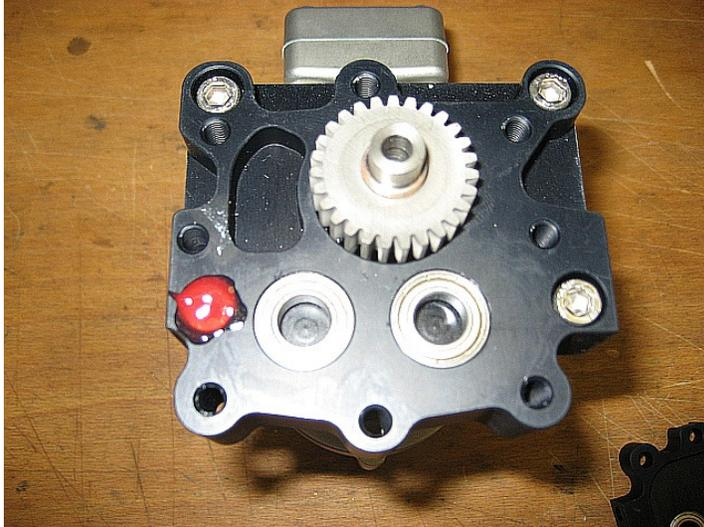
Nach dem Aushärten (die o.g. Dichtmassen werden nicht ganz hart) wird die überstehende Masse mit einer Rasierklinge abgezogen, Cuttermesser tut es genauso.
