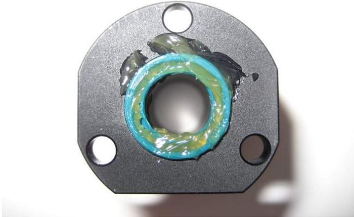
Jetzt die Führungshülse K4 bzw. B2 drehend über den Zapfen der Welle schieben (die Welle darf dabei auch noch mit etwas Öl benetzt werden) und mit den Schrauben K5 befestigen. Dann wird K29 montiert.
