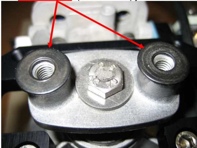
Dann auf die Gewinde der beiden Spezialschrauben der Kupplung auch etwas LOCTITE 243 drauf, die Federscheiben unter die Schraubenköpfe positionieren und das Ganze montieren.
