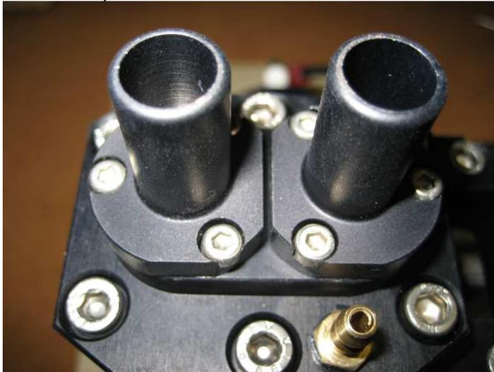
Wenn man jetzt an der Glocke dreht, stellt man fest, dass es etwas schwerer dreht wie ohne die beiden B2. Das ist die Reibung der beiden Dichtringe, was sich sicher aber nach ca. 1 Stunde Einlaufen gibt.
