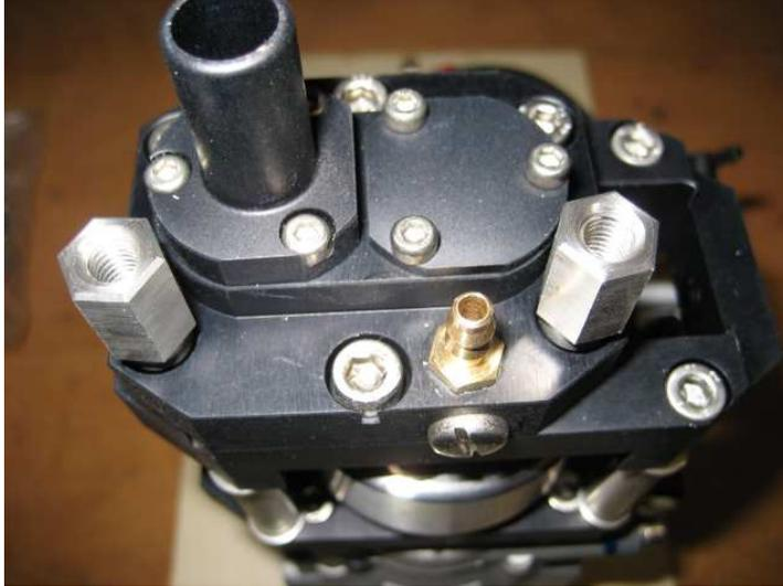
Diese K31 haben ein M6-Innengewinde und da passen dann die üblichen Gummilager (Silentblocks) wieder rein, diesmal axial, sodass die Einheit deutlich weniger breiten Einbauplatz beansprucht. Evtl. müssen die Stehbolzen der Silentblocks etwas gekürzt werden.
