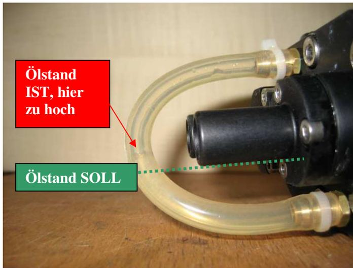
5. Nach jedem Fahren den Ölstand kontrollieren, speziell, wenn länger als 15 Minuten geheizt wurde. Und zwar bitte richtig, indem der Schlauch am oberen Nippel abgezogen wird und auf den Rumpfboden gelegt wird. Es muss dann Öl beginnen zu fließen. Wenn das nicht gemacht wird, dann besteht die Gefahr, dass das Getriebe trocken läuft und dann erhebliche Schäden die Folge sind
