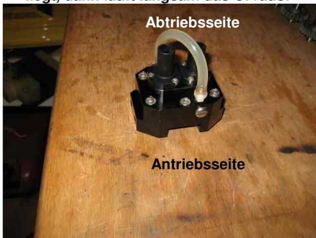
3. Daher wird zum Transport (Versand) das Getriebe ohne Öl ausgeliefert, dieses ist vor der ersten Inbetriebnahme einzufüllen. Man nehme die Spritze und ziehe 2ml handelsübliches PKW-Getriebeöl, egal ob Handschalter- oder Automatiköl, auf. Dann wird dieses Öl über den Schlauch in das Getriebe eingedrückt.
